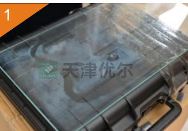
中度玻璃发霉的状态，将一部分用胶带封住，待后面观察修复后的对比效果。
